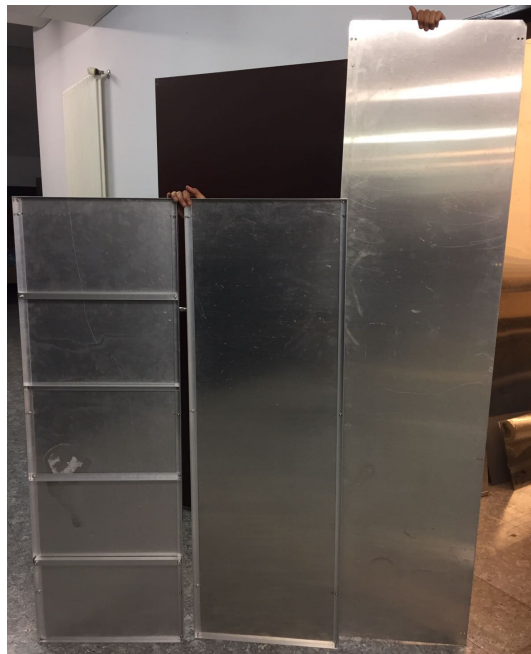
Fig. 3.2: A destra gli specchi del LAM precedente, al centro la lastra riflettente tagliata (1,5 m per 0,5 m) e a sinistra il risultato finale degli specchi rinforzati.
