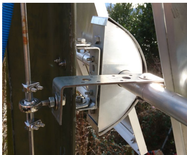
Fig. 3.10: Collegamento tra il centro di rotazione degli specchi e l'asta del motore per il movimento degli specchi.
