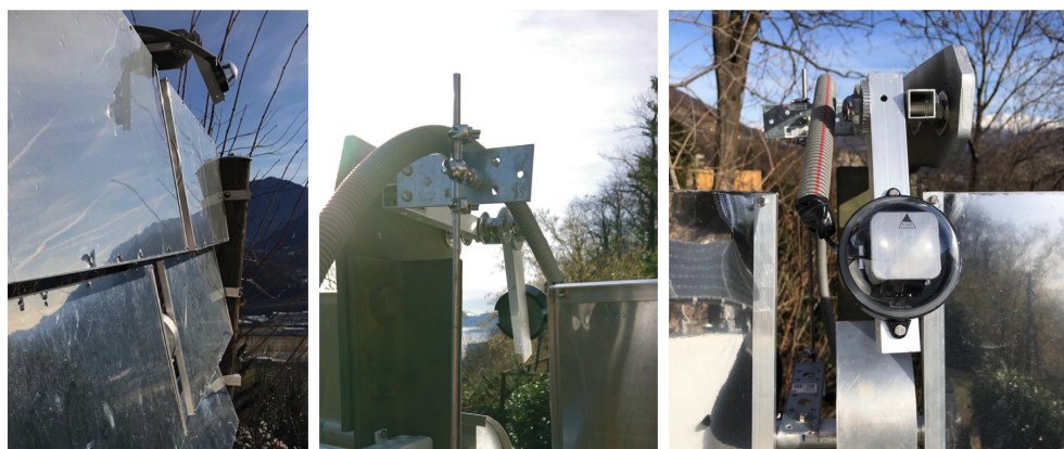
Fig. 3.9: Foto del sensore di luce; al centro la foto che illustra il collegamento tra l'asta verticale, i profili in alluminio, gli ingranaggi e il sensore.
