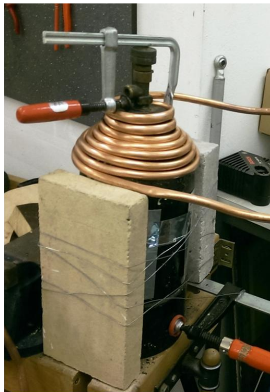
Figura 20: La spirale riportata indica una prova, conclusa con successo, dell'avvolgimento del rame.
