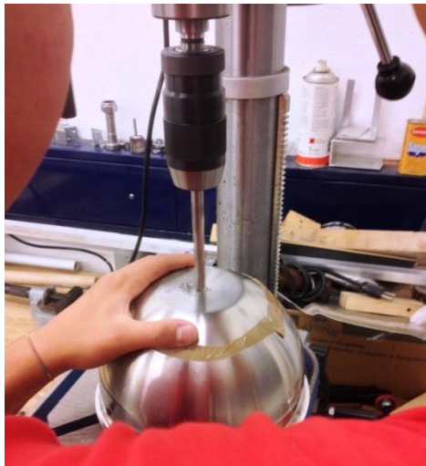
Figura 28: La ciotola è stata traforata per inserire la lunga vite che permette al ricevitore di stare sospeso e contemporaneamente di stabilizzarsi a una distanza ideale dal fuoco del paraboloide.
