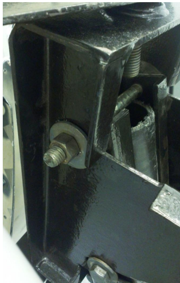
Figura 43: In questa figura si può notare il corpo di ferro della parabola, il quale è costituito da due casse di ferro, una esterna una interna. Quest'ultima è stretta al palo creando una forte stabilità e inoltre è legata mediante viti alla cassa esterna, la quale, oltre a sorreggere il disco parabolico, ha il compito di spostarlo, compiendo un movimento attraverso l'incavo a forma di quarto di circonferenza.
