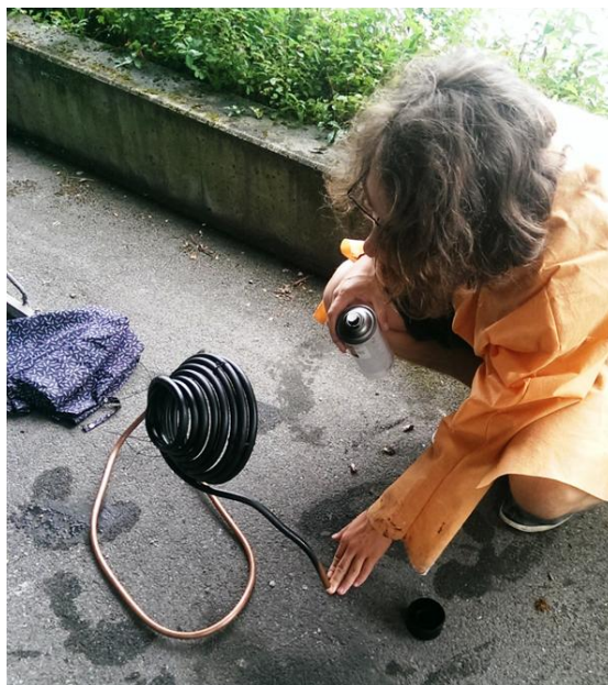
Figura 21: La spirale definitiva è stata verniciata, aumentando l'indice di assorbimento del rame e di conseguenza aumentando la capacità di conversione dell'energia dalla radiazione solare al metallo.
