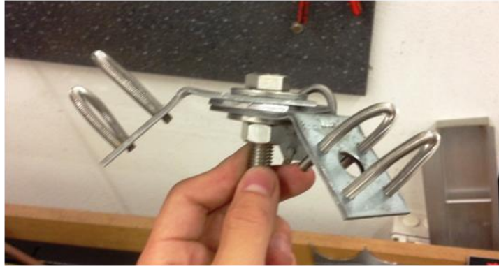
Figura 27: Questa figura rappresenta il sistema di lastre di acciaio piegate. La foto riportata illustra la struttura quasi terminata. Infatti possiede le componenti provenienti dalla barra filettata già ultimate.
