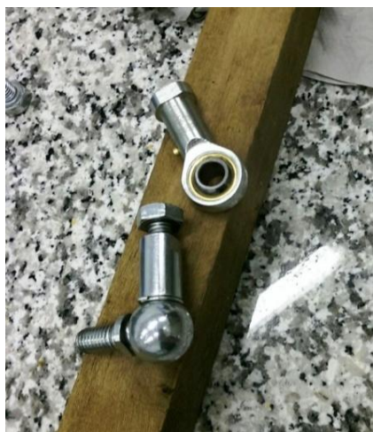
Figura 36: Il sistema elaborato con gli snodi non forniva un buon esercizio della parabola. Infatti si possono notare le molteplici capacità di moto dei pezzi in figura, ciò produceva movimenti imprecisi e casuali del disco parabolico.
