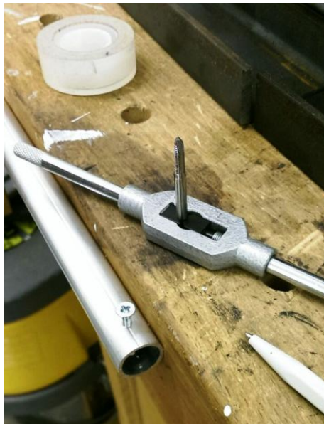
Figura 31: Dopo i fori dei tubi di rivestimento, abbiamo adoperato un giramaschio con un maschio di grandezza adeguata (M4) per fare il filetto, all'interno dei fori praticati nell'alluminio.
