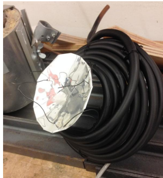
Figura 22: In questa figura viene rappresentato come abbiamo agganciato il cono riflettente alla base inferiore della spirale. In seguito i fili di ferro sono stati tirati rendendo il cono stabile. Dopo aver terminato il lavoro inerente la parte centrale del ricevitore, abbiamo provato a inserire la spirale al suo interno per vedere se effettivamente tutte le misure corrispon-
