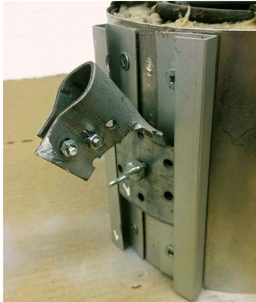
Figura 17: Il pezzo sovrastante, nonostante si tratti di un'idea ingegnosa e creativa, non è stata sufficiente per compensare i difetti che rendono questo "receiver" poco performante.
