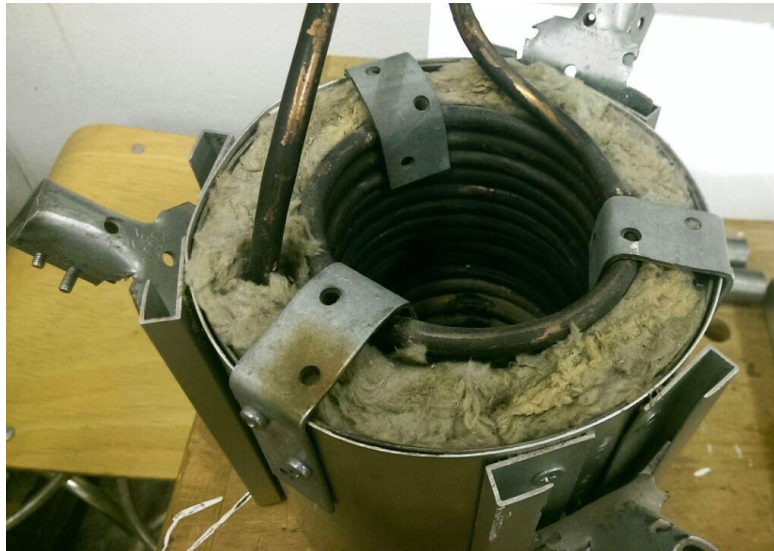
Figura 18: Da questo ingrandimento del primo ricevitore si può osservare che la lana di roccia isolante è bruciata, ciò sta a indicare che il diametro della bobina è insufficiente ad accogliere la radiazione solare riflessa dallo specchio parabolico.
