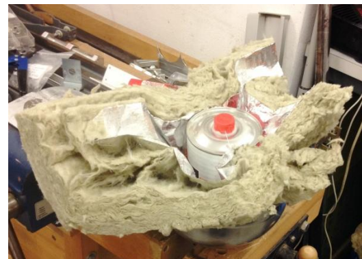
Figura 24: L'isolazione termica è stata effettuata in maniera diversa rispetto al primo ricevitore. Infatti la forma semisferica è difficile da riprodurre, perciò abbiamo pressato la lana di roccia con l'aiuto di un recipiente, affinché tutta la ciotola risultasse isolata. Inoltre abbiamo lasciato la parte di alluminio dell'isolazione termica all'interno, così facendo la radiazione passante attraverso le fessure della spirale viene riflessa nuovamente sul tubo di rame.
