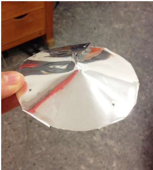
Figura 23: Il cono di alluminio è stato rivestito di mylar, in modo che favorisca la riflessione sulla bobina di eventuali raggi di luce sfuggiti all'assorbimento del rame.
