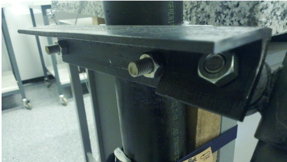
Figura 38: Questa è la struttura a L che permette al motore 1 di mantenere una buona posizione in rapporto alla barra di ferro sul quale attua la forza. Inoltre la struttura a L possiede una maggiore robustezza e solidità rispetto a una singola lastra.
