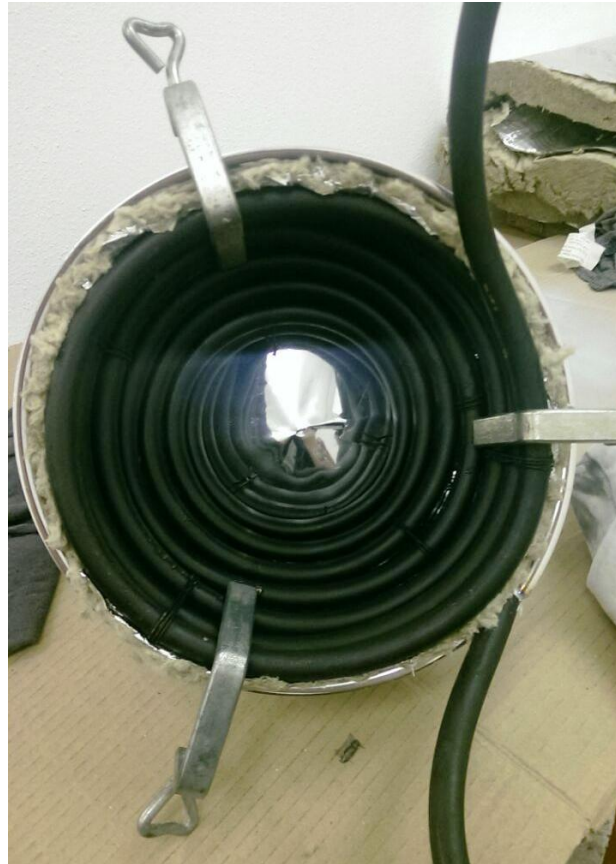
Figura 26: Versione frontale della nuova versione del ricevitore, si può notare l'ampio diametro della spirale, il cono riflettente posto sul fondo della bobina, l'isolazione della lana di roccia a lato del tubo di rame e le morse leggermente piegate che sorreggono tutta la struttura.
