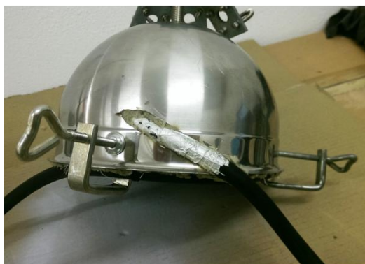
Figura 25: A causa di motivi strutturali è risultato necessario effettuare un taglio, nell'ordine della decina di centimetri della parete esterna del ricevitore, ciò favorisce la fuoriuscita della parte finale del tubo.
