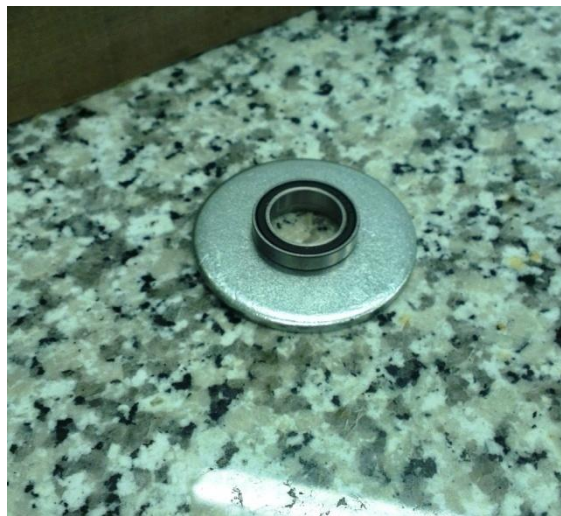
Figura 41: Questo cuscinetto cilindrico viene inserito nel foro della cassa esterna, creato dalla vite, che rappresenta il centro dell'incavo, e bloccato tramite la renella sul quale poggia. Così facendo viene a crearsi una maggiore integrità, evitando alla vite e alla cassa di ferro di entrare in contatto, generando attrito.
