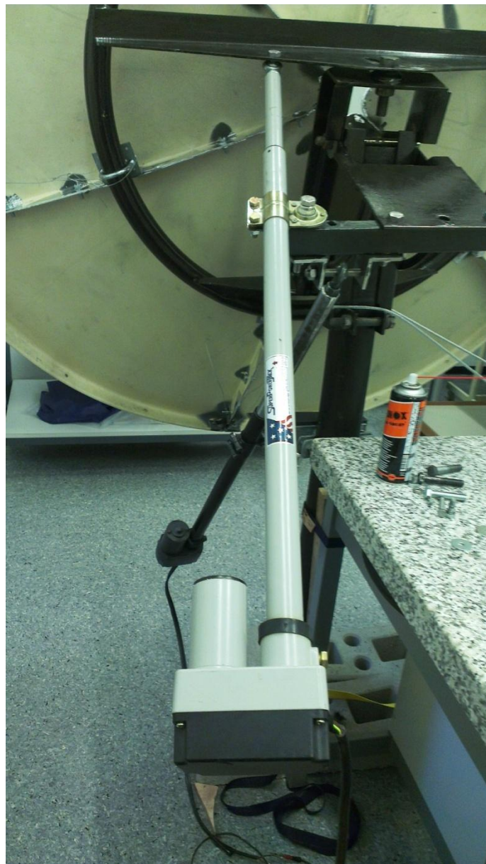
Figura 46: Questo è il motore 2, si può vedere chiaramente come sia collegato con la parabola e la barra di ferro che viene spostata dal motore 1. Inoltre in alto a destra si può notare il bullone che passa attraverso un cuscinetto sferico, ciò permette il movimento dell'angolo azimutale.
