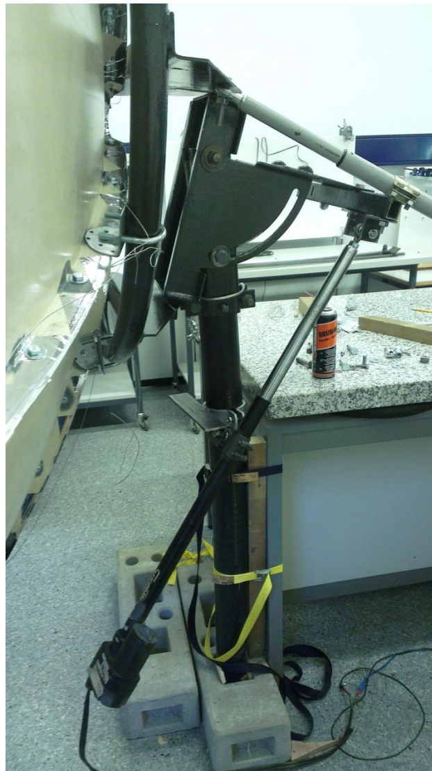
Figura 44: Il motore 1 è stato riportato durante il suo stato di massima estensione, chiamato da noi angolo 0. Si può notare in centro la struttura in ferro a L descritta precedentemente e in alto a destra la congiunzione del mo-
