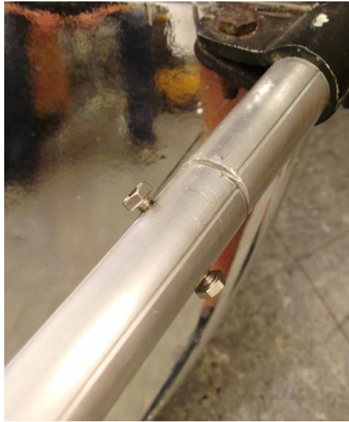
Figura 32: In questa figura viene illustrata la chiusura del rivestimento di alluminio dei bracci della parabola.
