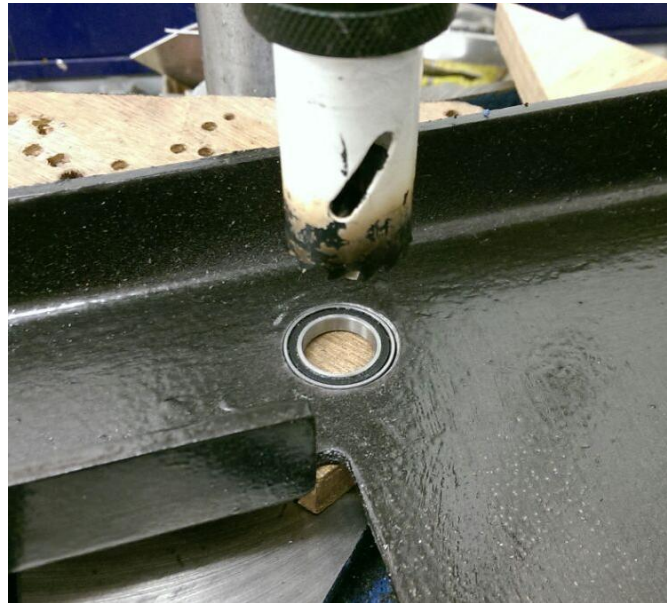
Figura 42: Nella sovrastante figura si vede chiaramente il cuscinetto cilindrico inserito perfettamente (sia in termini di profondità, sia in larghezza) nel foro dove passerà la vite. Per allargare l'incavo abbiamo dovuto utilizzare l'utensile visibile in alto, ossia una tazza di diametro 25 mm, ma per l'imprecisione il diametro risultante è pari a 26 mm, uguale al diametro esterno dei nostri cuscinetti.
