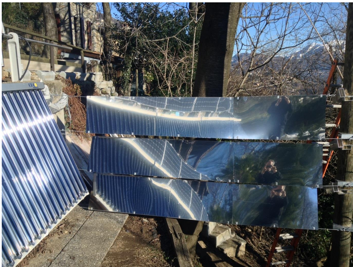
Figura 11: Specchio piano verticale semi-mobile per collettori cpc
