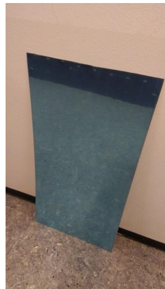
Figura 15: Lastra di alluminio con Mylar
