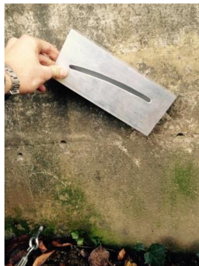
Figura 16: Goniometro con angolo di 20° posizionato sull'arco d'angolazione
