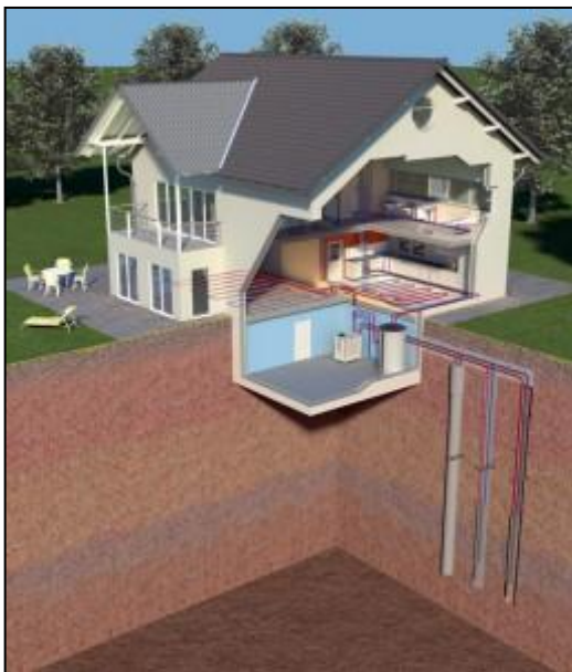
Figura 2.7: impianto geotermico a sonde verticali.
