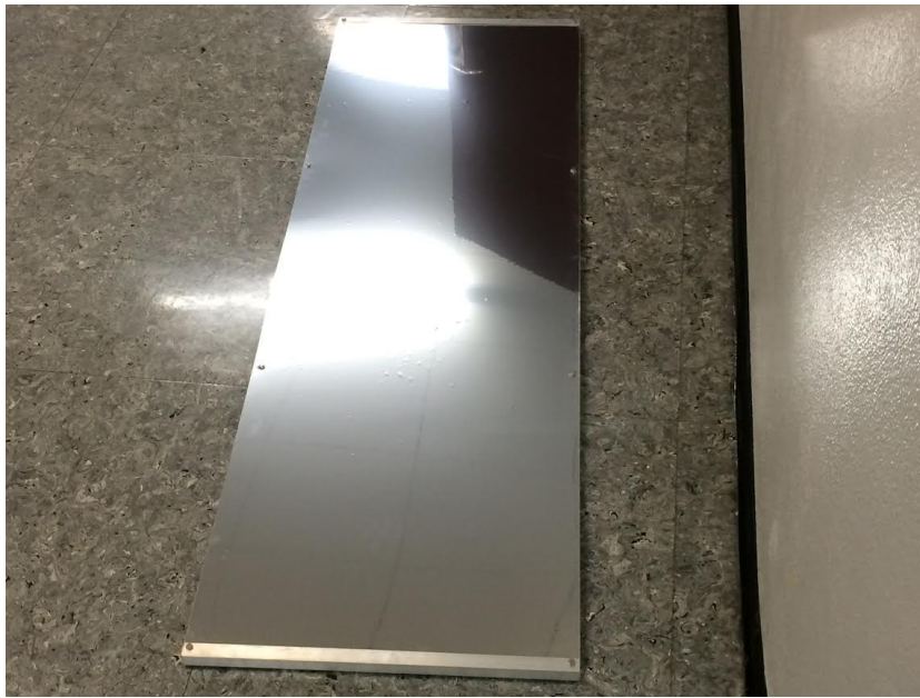
Figura 9: Uno dei vari specchi realizzati "in casa", si noti il film riflettente (Mylar) e il profilo in alluminio dove lo specchio verrà fissato alle barre verticali. Il tutto pesa meno di 2.5 kg
