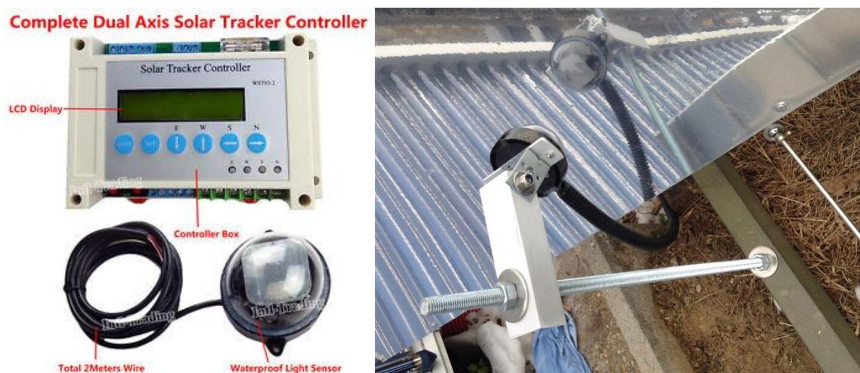
Figura 16a e 16b: A sinistra, il sistema sensore+processore acquistato; a destra, il sensore (fisso) che si occupa dell'angolo zenitale. Come si può notare, questo è piazzato molto vicino allo specchio di cui capta la riflessione (per una motivazione di questa decisione, si veda il paragrafo 7).
