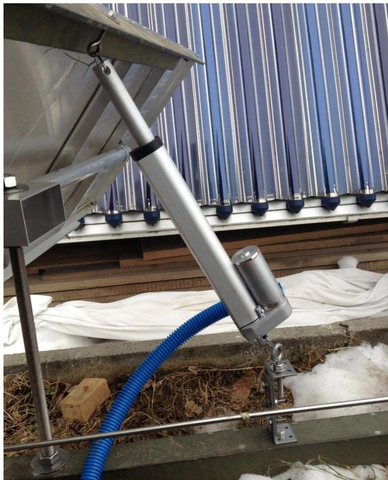
*Figura 13: Il motore che si occupa dell'inclinazione zenitale, si noti il rinforzo verde sulla parte superiore dello specchio.*
