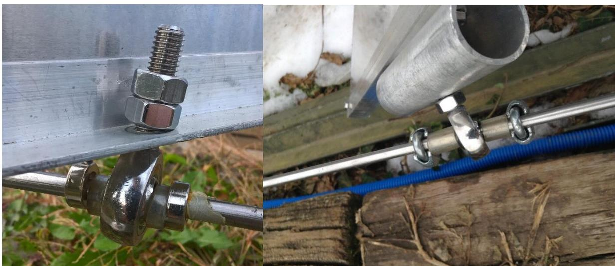
Figura 12: Il collegamento, tramite rod end, di specchio e sbarra di collegamento: a sinistra, quello inferiore; a destra, quello laterale, con il cilindro che permette l'inclinazione del rod end.
