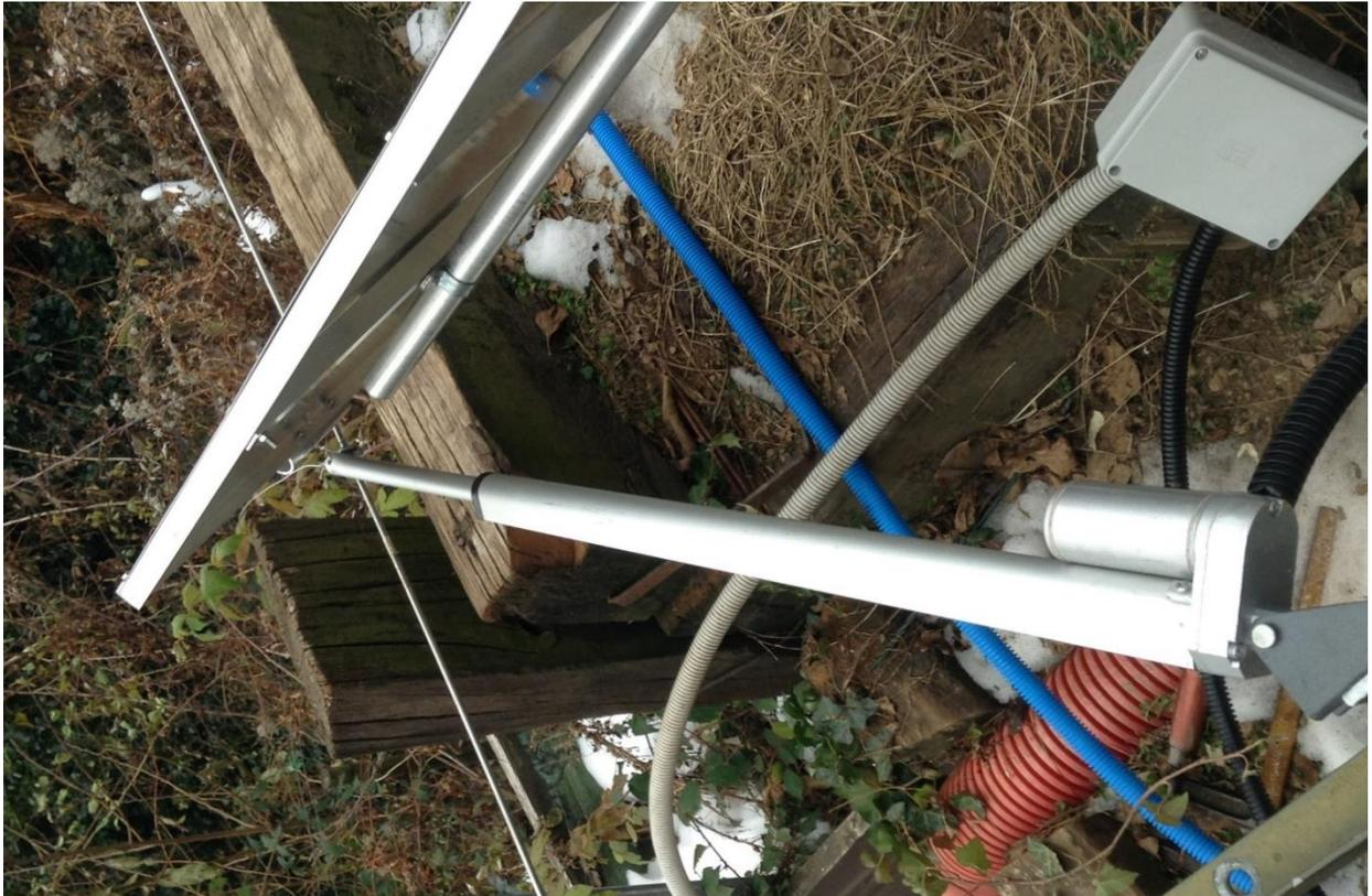
*Figura 14: L'attuatore del movimento azimutale. Questo è sopraelevato e può muoversi solo orizzontalmente (in modo parallelo al suolo).*
