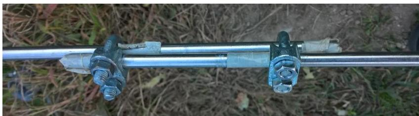
Figura 11b: unione di due sbarre di collegamento.
