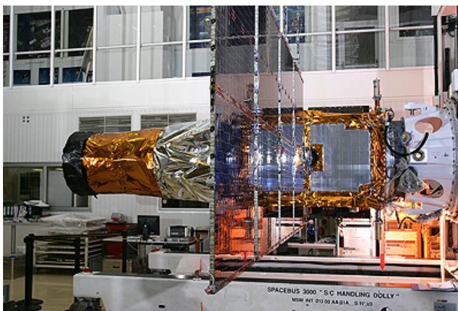
Figura 58: Il satellite Corot sottoposto a prove di qualificazione meccanica a Cannes nel febbraio del 2006.
