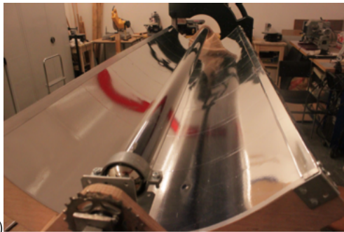
Figura 1: Queste immagini mostrano il nostro prototipo di collettore solare, installato con uno dei tubi sottovuoto che utilizzeremo per la produzione in serie.
